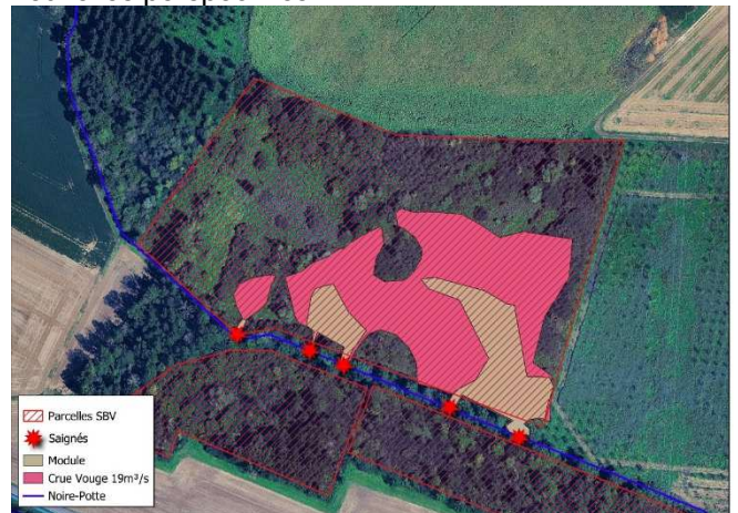
Différence de surface inondée de la Zone Humide entre un débit moyen et une crue de la Noire Potte
